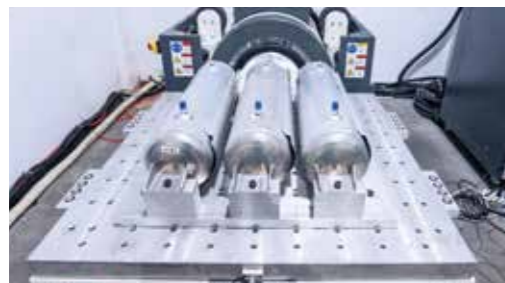
振动试验台 / Vibration Test Bench
