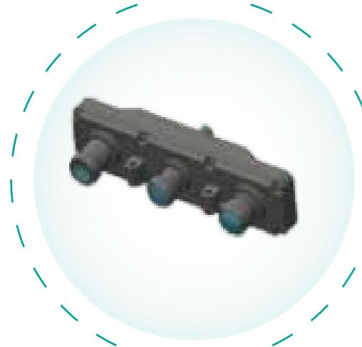
三目立体视觉模组实现多功能应用，两侧同质化图像传感器实现视差图输出，得到3D点云，远距离测量，完成立体视觉的检测，获得目标的深度信息，辅助车辆精准避障。中间设置广角高分辨率图像传感器，用于覆盖大范围前方场景，补足车辆盲区，对于近距离移动目标的跟踪、识别及避让起到重要作用，尤其是对近距离行人及非机动车的横穿场景，能够准确预判，避免事故或减少事故程度。
