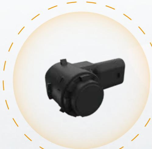
DSI3通信的超声波雷达（AK2），一般安装于车辆前后位置各4个 + 侧面各2个，用于自动泊车、自动驾驶。AK2超声波雷达测距能力强，能够满足各类车型搭载智能泊车系统的障碍探测需求；兼备8K调频带宽，可同时发送和接收不同的声波信号，避免同频干扰；信号传播速度快，且能够同步处理多种回波特征值，支持多模式切换，满足智能驾驶迭代至L3、L4级对感知升级的要求。
