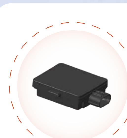
角雷达通过发射电磁波、对回波信号的检测，反馈目标与雷达的相对距离、速度、角度，可在商用车、乘用车、工程车以及其他特殊车辆行驶过程中准确提示驾驶员盲区障碍物。集BSD、LCA、RCW、RCTA、DOW、RCTB、FCTA、FCTB功能集于一体，同时可提供感知目标信息给域控用于高阶智驾功能，有效降低成本。
