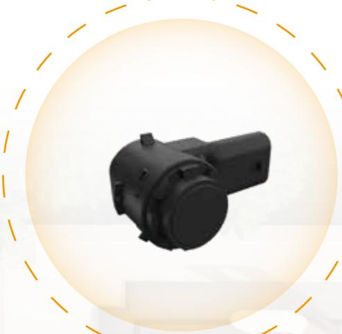
超声波倒车雷达凭借穿透力强、衰减小、反射能力强，对光照、色彩、电磁场不敏感、不易受恶劣天气影响、测距原理简单、测距精度高、成本低等特点，已经逐渐成为乘用车的标准配置。ELS雷达安装在车辆的前后保险杠上，用于测量汽车前后障碍物的用于泊车辅助雷达，探测距离一般在15~150cm之间。
