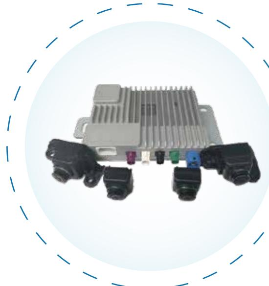
360全景影像环视系统通过安装在车身前、后、左、右的四个超广角摄像头实时采集车辆周围影像，对图像进行矫正、视角变换和拼接处理后，形成一幅360°全景鸟瞰图画面，辅助驾驶员了解车辆周围盲区环境，从容操控车辆通过复杂路段，泊车入位，避开障碍物，有效减少刮蹭、碰撞、陷落等事故的发生。
