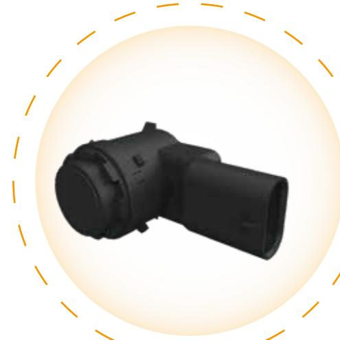
UPA / APA 超声波雷达，安装在车辆的前后和侧面，IO通信接口的超声波雷达，一般前后各4个+侧面各2个，测量侧方障碍物距离，用于自动泊车。探测距离可以达到20~500cm之间，更远的探测距离让APA超声波雷达可以检测左右侧的障碍物，还能根据超声波雷达返回的数据判断停车位或者路沿是否存在。另外UPA雷达一般也多用于泊车辅助系统
